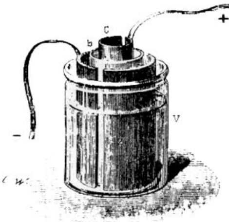
Un modèle classique de la pile de Daniell.
